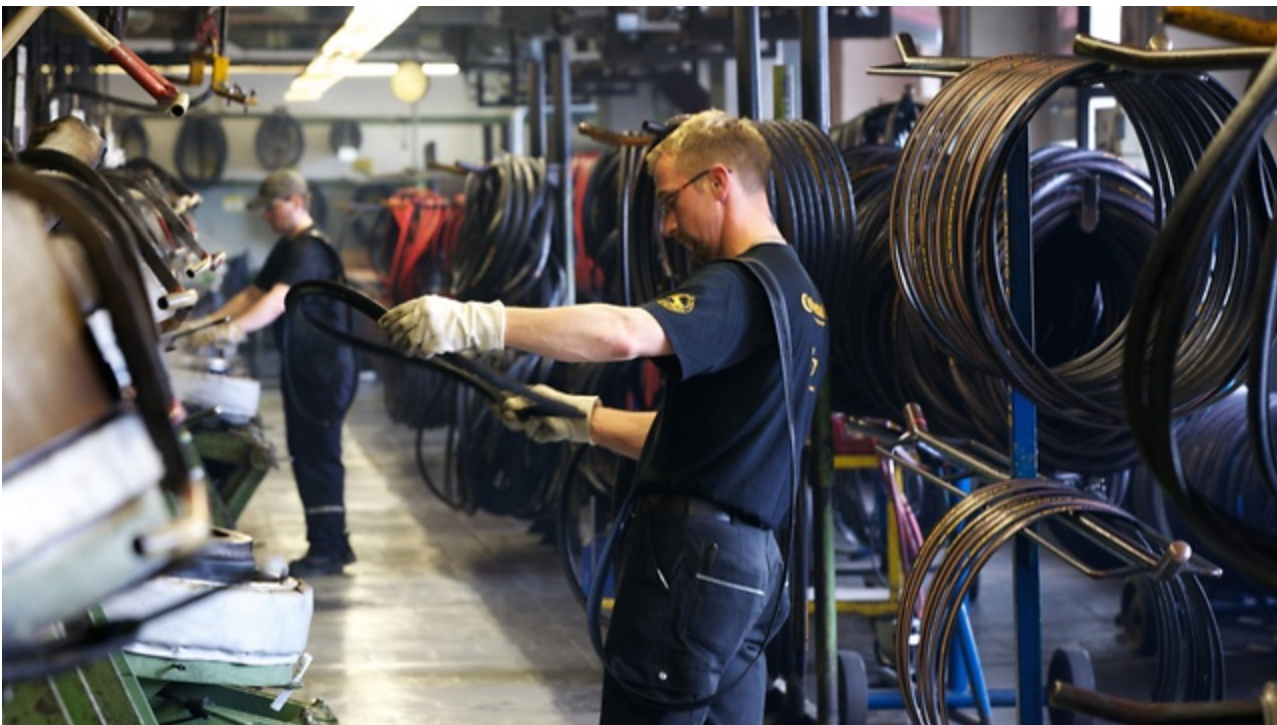
Ein Beschäftigter prüft die Fahrradreifen nach der Vulkanisation im Continental-Werk in Korbach.
