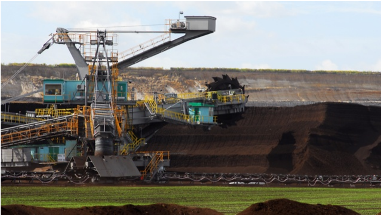
Schaufelradbagger SRS 2000 im Braunkohlentagebau - Vereinigtes Schleenhain
